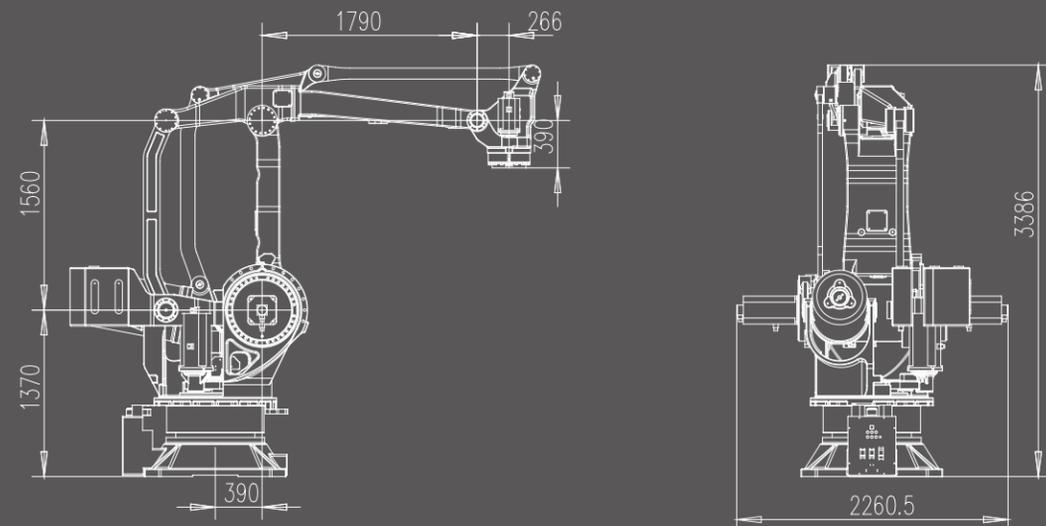
A向视图 (末端法兰安装尺寸)
