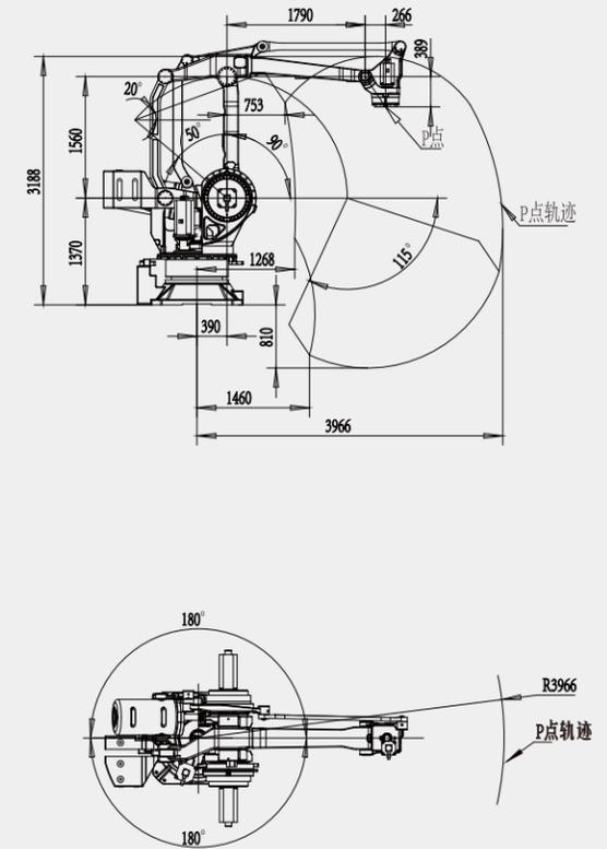
SF1600-C4000 PA机器人外观及安装尺寸
